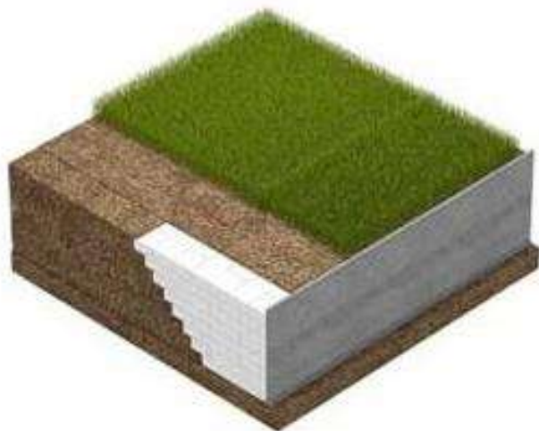
Retaining & Buried Wall Backfill Τοίχοι αντιστήριξης
